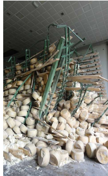
Collasso di scaffalature in acciaio non adeguatamente collegate alla struttura ed indotte al collasso dal carico sostenuto
